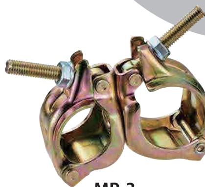
MP-3 サポートクランプ自在 規格 /Φ60.5×Φ48.6・Φ42.7 兼用 入数 /30個 単重 /700g
