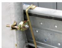
シングル スイングホルダー (板タイプ) 規格 / \phi 48.6 \cdot \phi 42.7 兼用 表面処理 / クロメートメッキ 単重 / 700g A=48mm
