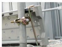
シングル スイングホルダー (板タイプ) 規格 / \phi 48.6 \cdot \phi 42.7 兼用 表面処理 / クロメートメッキ 単重 / 700g A=48mm
