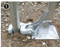
杭抜きをパイプにセット。
