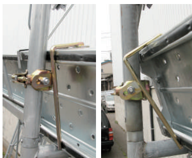
ダブル スイングホルダー (板タイプ) 規格 / \phi 48.6 \cdot \phi 42.7 兼用 表面処理 / クロメートメッキ 単重 / 720g A=95mm
