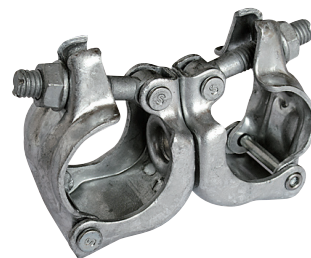
φ42.7クランプ自在 規格 / φ42.7×φ42.7 入数 / 30 個 単重 / 620g ※溶融亜鉛メッキ（ドブメッキ）仕様
