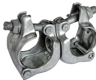
φ42.7クランプ自在 規格 / φ42.7×φ42.7 入数 / 30 個 単重 / 620g ※溶融亜鉛メッキ（ドブメッキ）仕様
