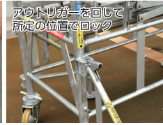
アウトリガーを回して 所定の位置でロック
