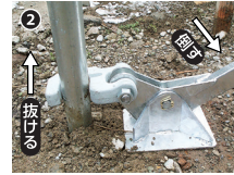
手前に倒すと杭が抜けます。
