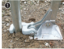
杭抜きをパイプにセット。
