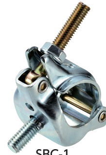
SBC-1 伸縮ブラケット用先端クランプ 規格 / φ48.6・φ42.7 兼用 入数 / 50個 単重 / 394g
